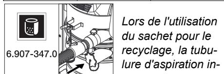
Lors de l'utilisation du sachet pour le recyclage, la tubulure d'aspiration inférieure doit être fermée de manière étanche.
