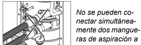
manguito de aspiración tiene que estar cerrado herméticamente con el manguito de conexión.
