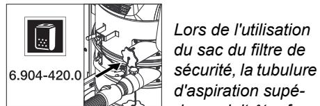
Lors de l'utilisation du sac du filtre de sécurité, la tubulure d'aspiration supérieure doit être fermée de manière étanche.
