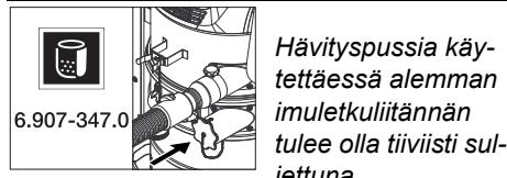
Hävityspussia käytettäessä alemman imuletkulitiänän tulee olla tiiviisti suljettuna.
