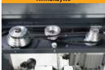
Kuva: Hihnakäyttö DQ 22. DQ 14/18 kahdella hihnapyörällä.
